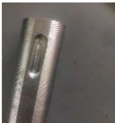
Figura 43. Ranurado de eje para cuñero.
