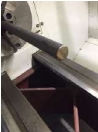
Figura 48. Maquinado de eje en torno cnc.
