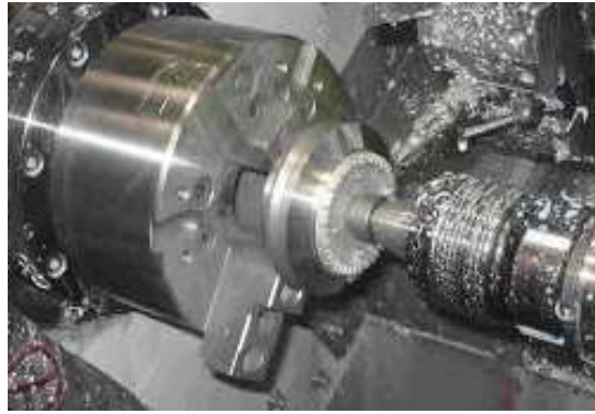
Figura 8. Proceso de torneado.
